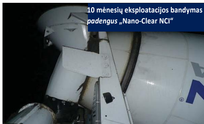
Net ir lipnios betono dulkės lengvai atsiskiria nuo „Nano-Clear NCI“
